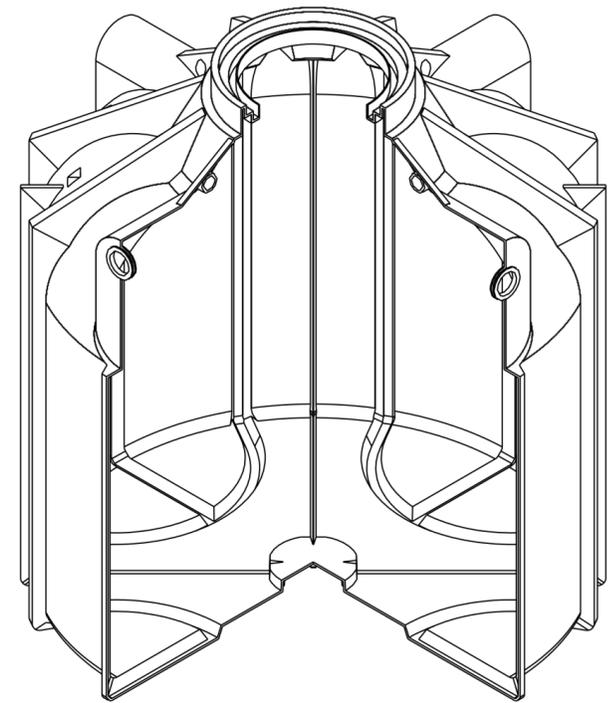
Der Überlauf kann variabel nach Kundenwunsch in eine der Spiegelflächen gesetzt werden, welche nicht durch den Zulauf oder die Versorgung belegt sind. Die Bohrung des Überlaufs sollte 100mm unter der Bohrung des Zulaufs positioniert werden.
