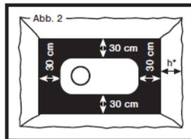
Bei Verwendung einer Domverlängerung und / oder eines anderen Doms muss die Tiefe der Grube entsprechend angepasst werden.
