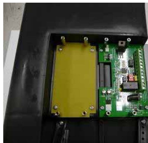
Linke gelbe Frontplattenhalterung entfernen
